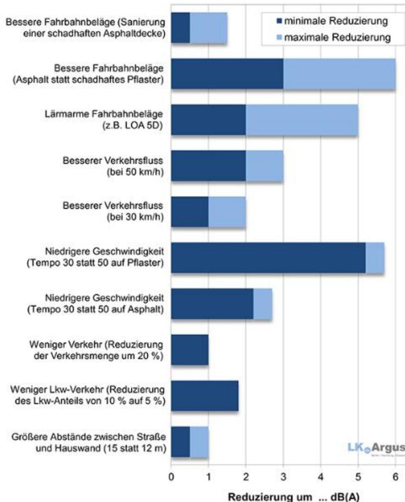
Abb. 6: Lärminderungspotentiale (Quelle:[http://www.umgebungslaerm.nrw.de/laermaktionsplanung/massnahmen\\_welche/index.php](http://www.umgebungslaerm.nrw.de/laermaktionsplanung/massnahmen_welche/index.php))
